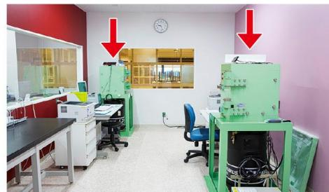
放射能検査には精度の高い「ゲルマニウム半導体検出器」を使います（矢印の位置）。測定には、検査する食品の量に応じて15分から12時間ほどかかります。
