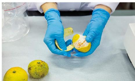
放射能検査をする食品は、国が定めた方法に従い、外皮を除くなど可食部だけに分ける作業が必要です。一つひとつ、ていねいな手作業で検査をしています。
