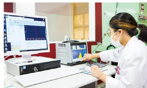
「ゲルマニウム半導体検出器」は、ガンマ線を測定することで放射能の種類や濃度を分析できます。パルシステムではセシウム134、137を測定しています。
