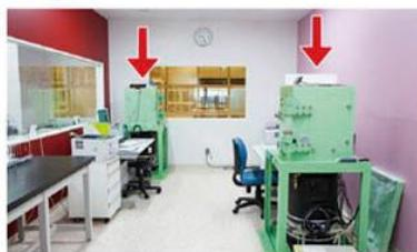
放射能検査には精度の高い「ゲルマニウム半導体検出器」を使います（矢印の位置）。測定には、検査する食品の量に応じて15分から12時間ほどかかります。
