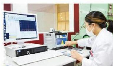
「ゲルマニウム半導体検出器」は、ガンマ線を測定することで放射能の種類や濃度を分析できます。パルシステムではセシウム134、137を測定しています。
