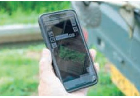
田植え直後の時期は、水を濁らせて雑草を抑制する「アイカメラ」が活躍。通ったあとが緑の線で表示されます。
