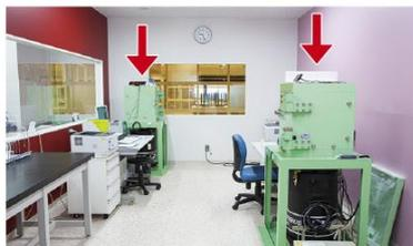
放射能検査には精度の高い「ゲルマニウム半導体検出器」を使います（矢印の装置）。測定には、検査する食品の量に応じて15分から12時間ほどかかります。
