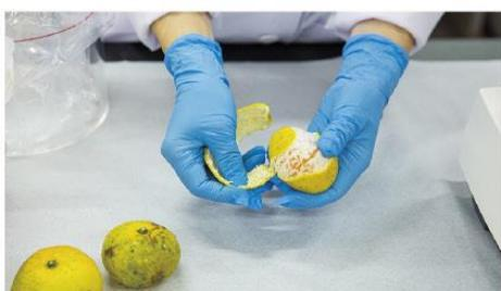
放射能検査をする食品は、国が定めた方法に従い、外皮を除くなど可食部だけに分ける作業が必要です。一つひとつ、ていねいな手作業で検査をしています。
