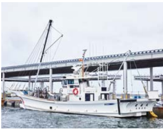
はたて漁に使う船。船首についている長いアームで網を引き上げます。
