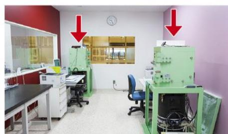
放射能検査には精度の高い「ゲルマニウム半導体検出器」を使います(矢印の装置)。測定には、検査する食品の量に応じて15分から12時間ほどかかります。
